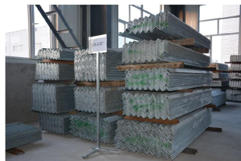
Угловая сталь для поддержки пролёта
